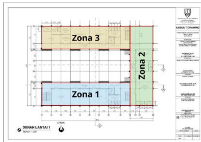
Gambar 1. Zonasi Pekerjaan Bekisting
