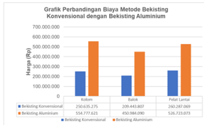
Gambar 2. Perbandingan Biaya Pekerjaan Bekisting Konvensional dengan Bekisting Aluminium
