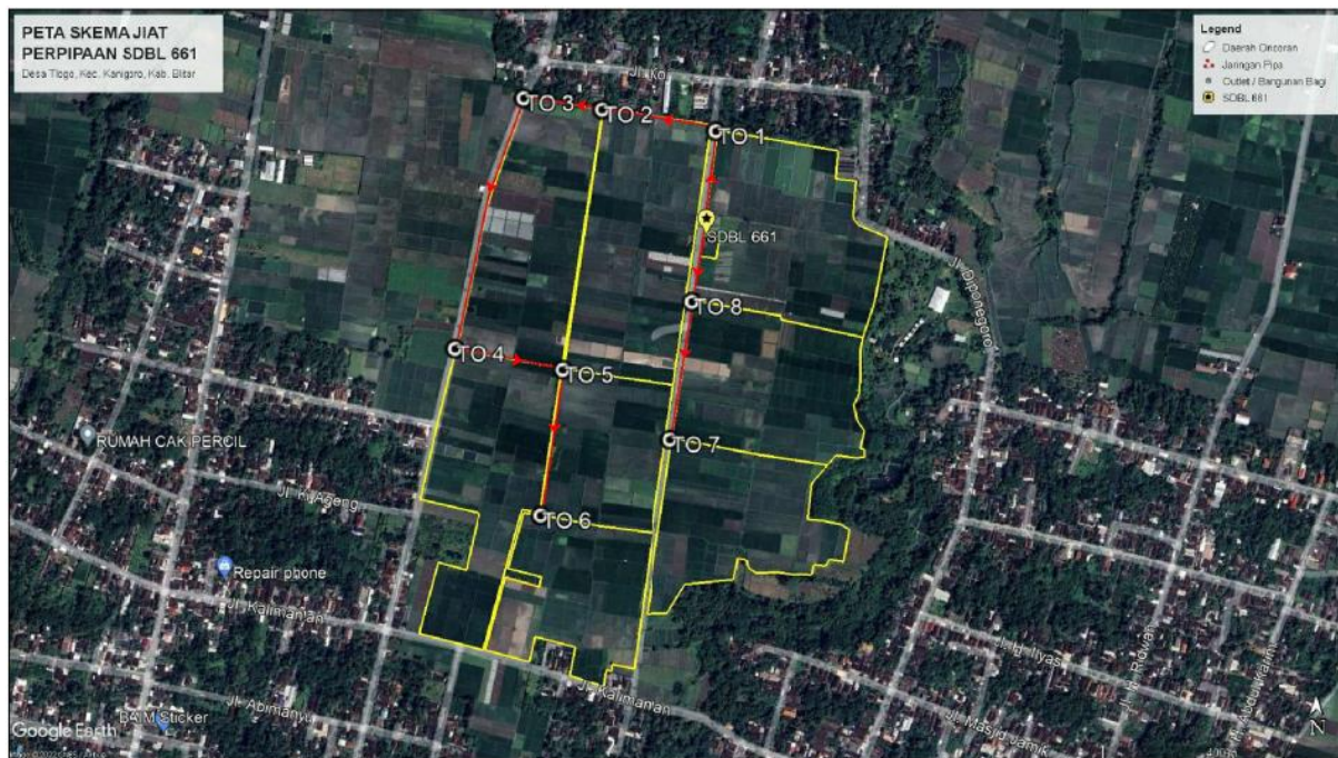
Gambar 3. Skema jaringan irigasi air tanah yang direncanakan
